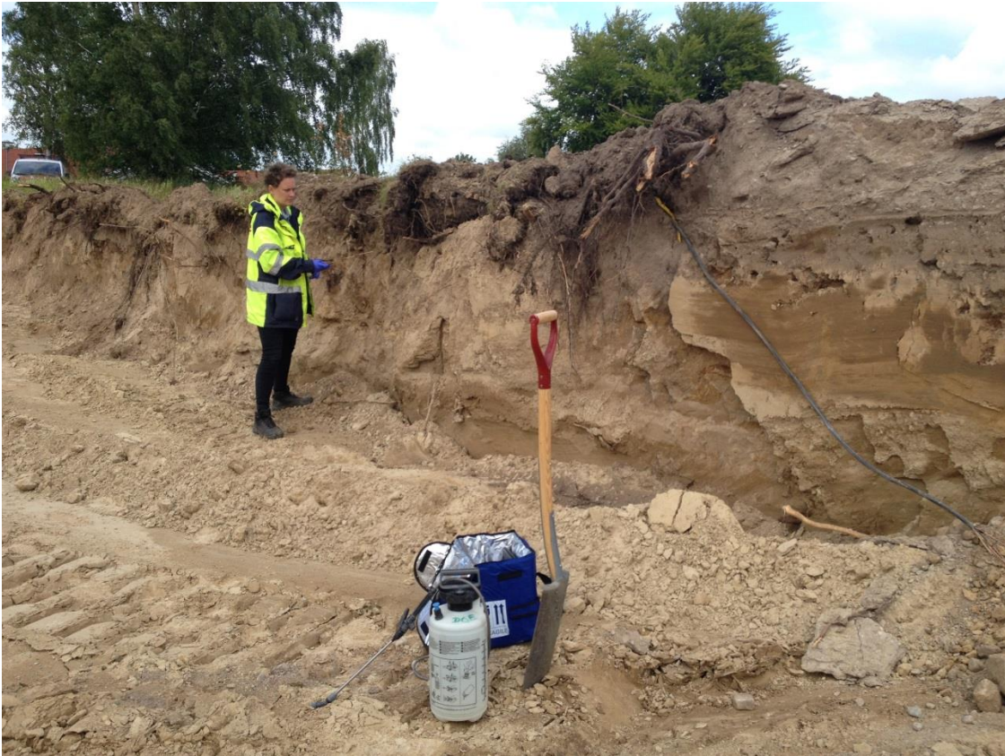
Bild 6. Provtagning vid det förorenade området som sanerades i samband med planläggningen.
