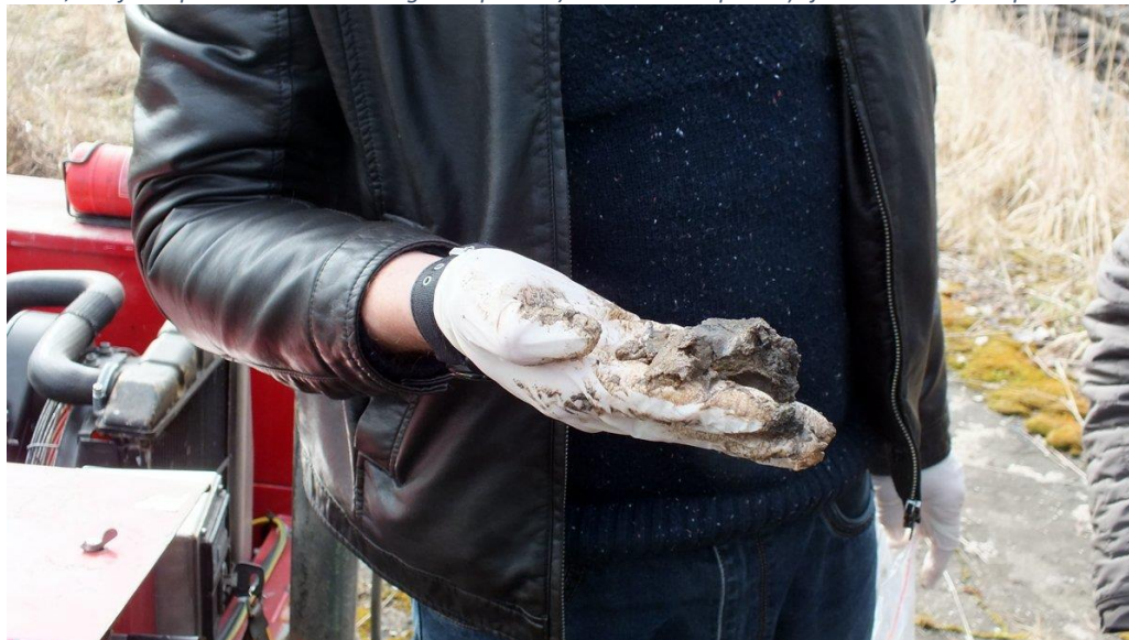
Attēls Nr. 7 Organoleptiski konstatējams piesārņojums ar naftas produktiem grunts paraugā aptuveni 1,5 m dziļumā pie mazuta pieņemšanas tvertnes
