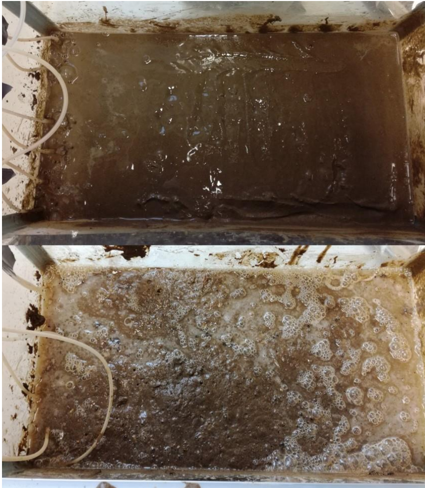
Liite 5. Havainnoiva kuva vaikutusalueiden eroista savimaalla syöttäen ilmaa (ylhäällä) tai vetyperoksidia (alhaalla). Sekä ilma että vetyperoksidi on syötetty maahan samanlaisten injektiokanavien kautta.
